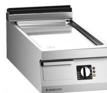
Elément grillade réalisé en acier inox AISI 304, dessus épaisseur 20/10 mm. Plaque de cuisson en bimétal (acier inox AISI316L+FE). SYSTEME COOKING-PRO. En dotation: bouchon plaque. Chauffe par résistances électriques en acier inox AISI 309, thermostat sécurité. Température de travail (min-max): 70-260°C. Pré-équipement pour raccordement à un optimiseur d'énergie.
